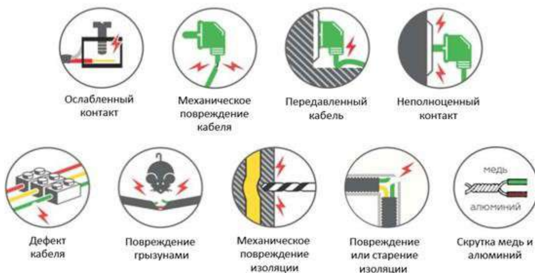
Рисунок 6. Возможные причины искрения в электропроводке
